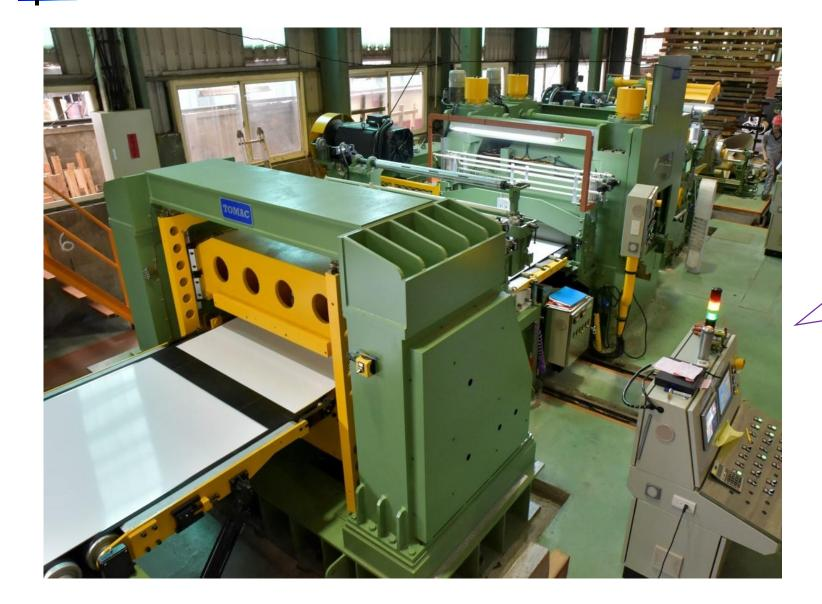
Cutting Process Shearing 、 Slitting 、 re-coiling
